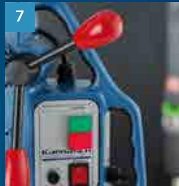
Toutes les machines sont équipées d'un système de refroidissement interne pour tous les porte-outils 19mm (3/4") Weldon et 32mm (1 1/4") Weldon.
